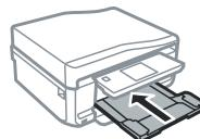
**B** Выдвиньте кассетный лоток.
